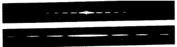
Figure 3 : diffraction par une fente large (en haut), et plus étroite (en bas)
