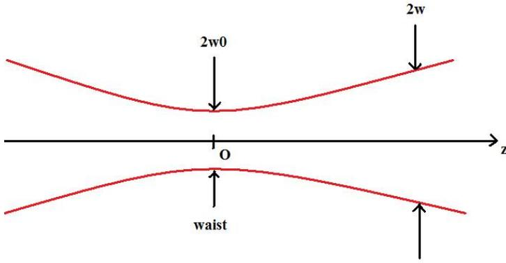
Figure 1: Le faisceau a une symétrie de révolution autour de l'axe Oz. Le diamètre du faisceau en un point d'abscisse  $z$  est  $2w$ , c'est à dire que  $w$  représente le rayon.  $w$  varie en fonction de  $z$ , et on appelle waist  $w_0$  sa valeur minimale. Par convention, la position du waist est en  $z = 0$ . La courbe hyperbolique tracée en rouge est l'enveloppe du faisceau : ce n'est pas un rayon lumineux.
