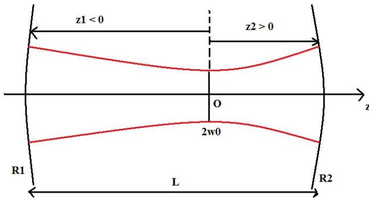
Figure 2: La cavité de longueur  $\ell$  est composée de deux miroirs de rayons de courbure  $R_1$  et  $R_2$ . On veut déterminer la distance algébrique  $z_1$  entre le waist et le miroir de gauche. L'origine est choisie au waist. On aura ainsi déterminé la position du waist dans la cavité. On pourra en déduire la distance de Rayleigh, puis la largeur du waist du faisceau.
