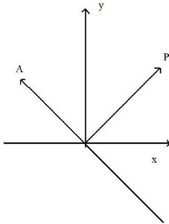
Figure 2: Polariseur et analyseur croisés.
