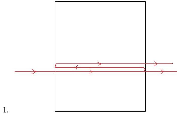
1. Figure 1: Rayon incident (incidence normale) et les deux premiers rayons transmis. En réalité, les rayons à l'intérieur du filtre sont superposés. On les a décalé pour plus de clarté.
